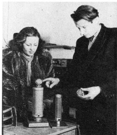
Bild 3. Dr. Rohde erklärt der Münchener Schauspielerin Hanna Rucker die Vorzüge des neuen Kondensatormikrofones (rechts) im Vergleich zu einer bisherigen Konstruktion (links)
